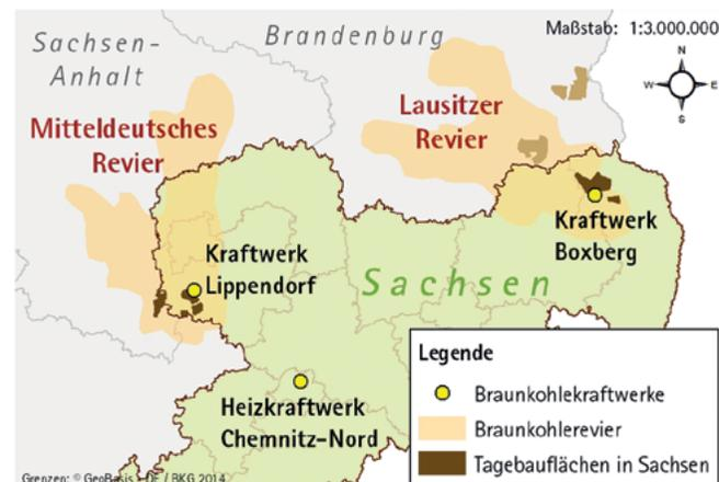
In Sachsen gibt es zwei große Braunkohlereviere: das Mitteldeutsche und das Lausitzer. Leistung und CO<sub>2</sub>-Ausstoß der sächsischen Kraftwerke: Lippendorf: 1.867 MW / 12,5 Mio. t; Boxberg: 2.575 MW / 15,1 Mio. t; Chemnitz-Nord (Block A: Heizöl/Erdgas, Block B u. C: Braunkohle): 195 MW / 1,14 Mio. t
