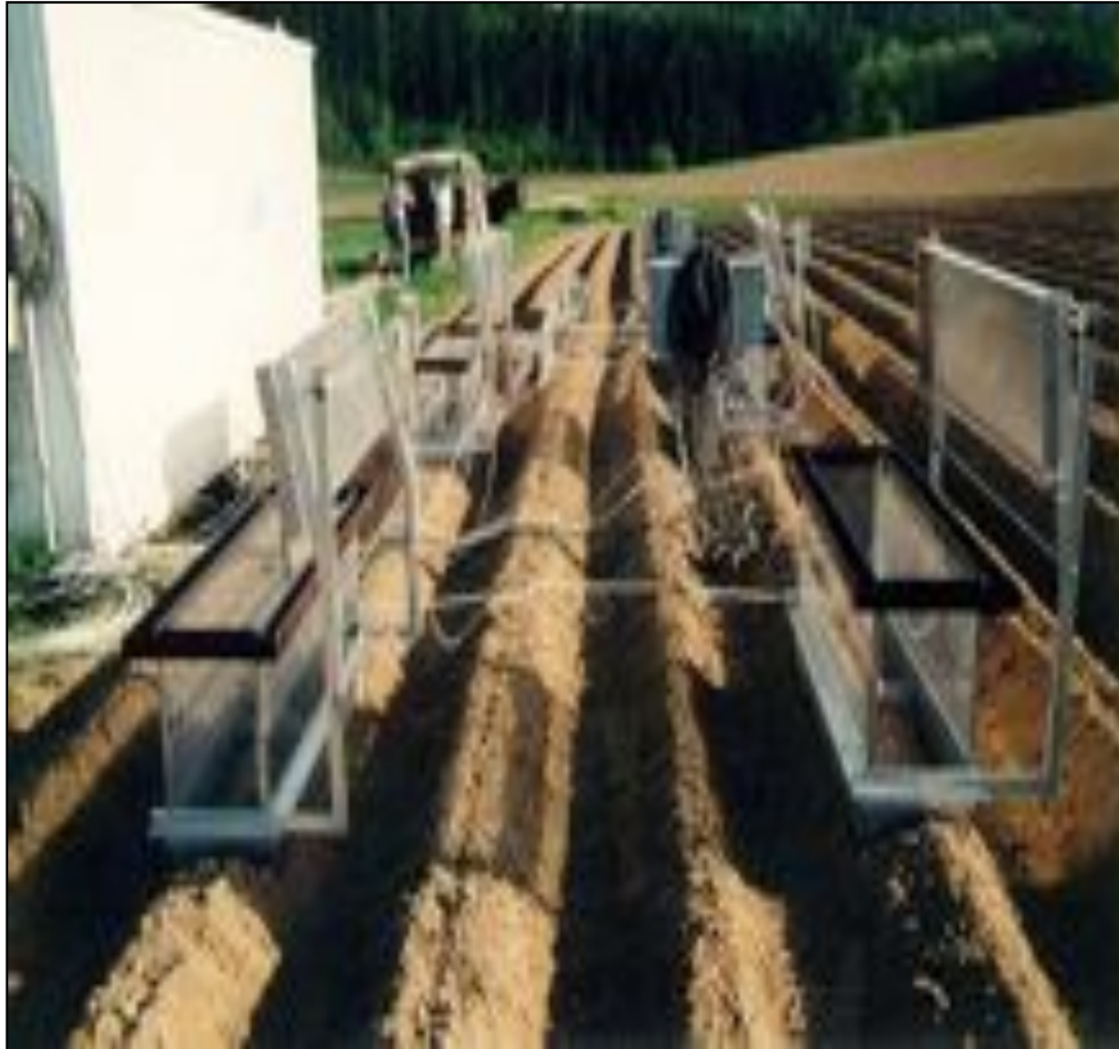
Feldlabor und Hauben zur Messung des Spurengasaustauschs (GSF-TUM)
